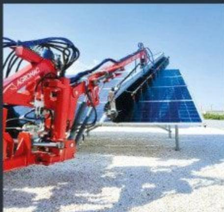
Teleskopik firça kolu sistemi ile traktör arasındaki bağlantı sağlanmaktadır. Sistem, traktör sürüş yolundaki zemin bozuklıklarının yarattığı vibrasyonu sönümlüyor ve panelerin zarar görmesini engeller.
