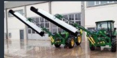
Mobil sistem doğru kullanıldığında hidrolik akümülatör ve kontrol ünitesi firçanın temas basıncının arazinin zor ve düz olmayan zeminlerde panelerin temizliği sırasında seviye dengelenmesini sağlar.
